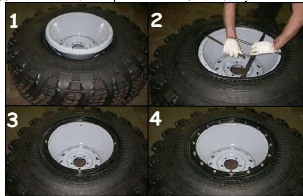
Рис. 10.4 Порядок монтажа шины ТРЭКОЛ
