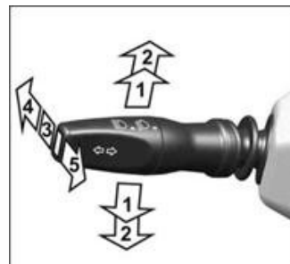
Рис. 5.11 Положение рычага указателей поворота и света фар
