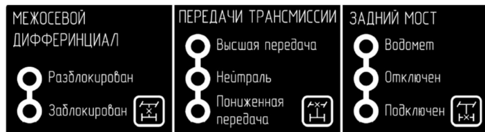
Рис. 6.13 Схема управления раздаточной коробкой и коробкой привода заднего ведущего моста с приводом водомётного движителя
