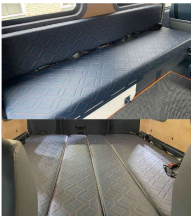
Рис. 20.40 Диваны мягкие пассажирского салона, трансформируемые в спальное место
