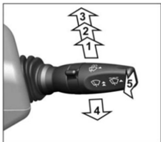
Рис. 5.10 Положения рычага переключателя стеклоочистителя и стеклоомывателя
