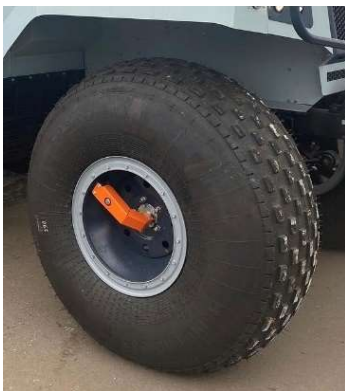
Рис.20.52 Система централизованной подкачки колёс
