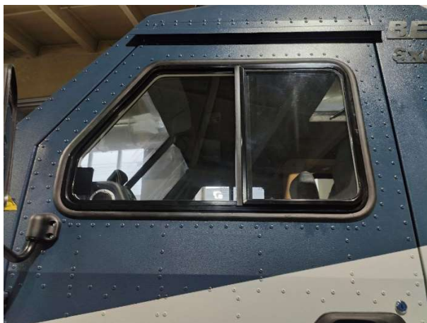
Рис.20.34 Стеклопакеты сдвижные – передние боковые двери
