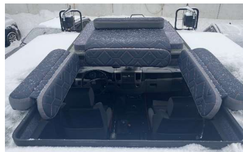
Рис.20.37 Мягкие опоры на быстроръемном креплении с обечайками люка
