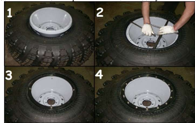
Рис. 10.4 Порядок монтажа шины ТРЭКОЛ
