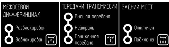
Рис. 6.12 Схема управления раздаточной коробкой и коробкой привода заднего ведущего моста без привода водомётного двигателя
