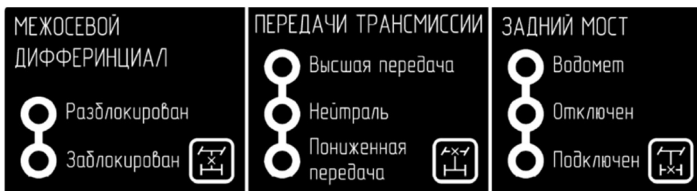
Рис. 6.13 Схема управления раздаточной коробкой и коробкой привода заднего ведущего моста с приводом водомётного двигателя
